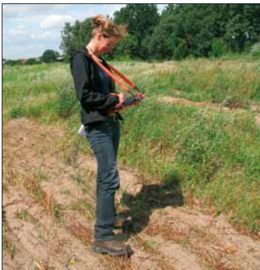
Abb. 9: Die Aufnahme von Verdachtsflächen erfolgte mit Tablet-PC und GPS-Anbindung. Foto: F. Glaser.
