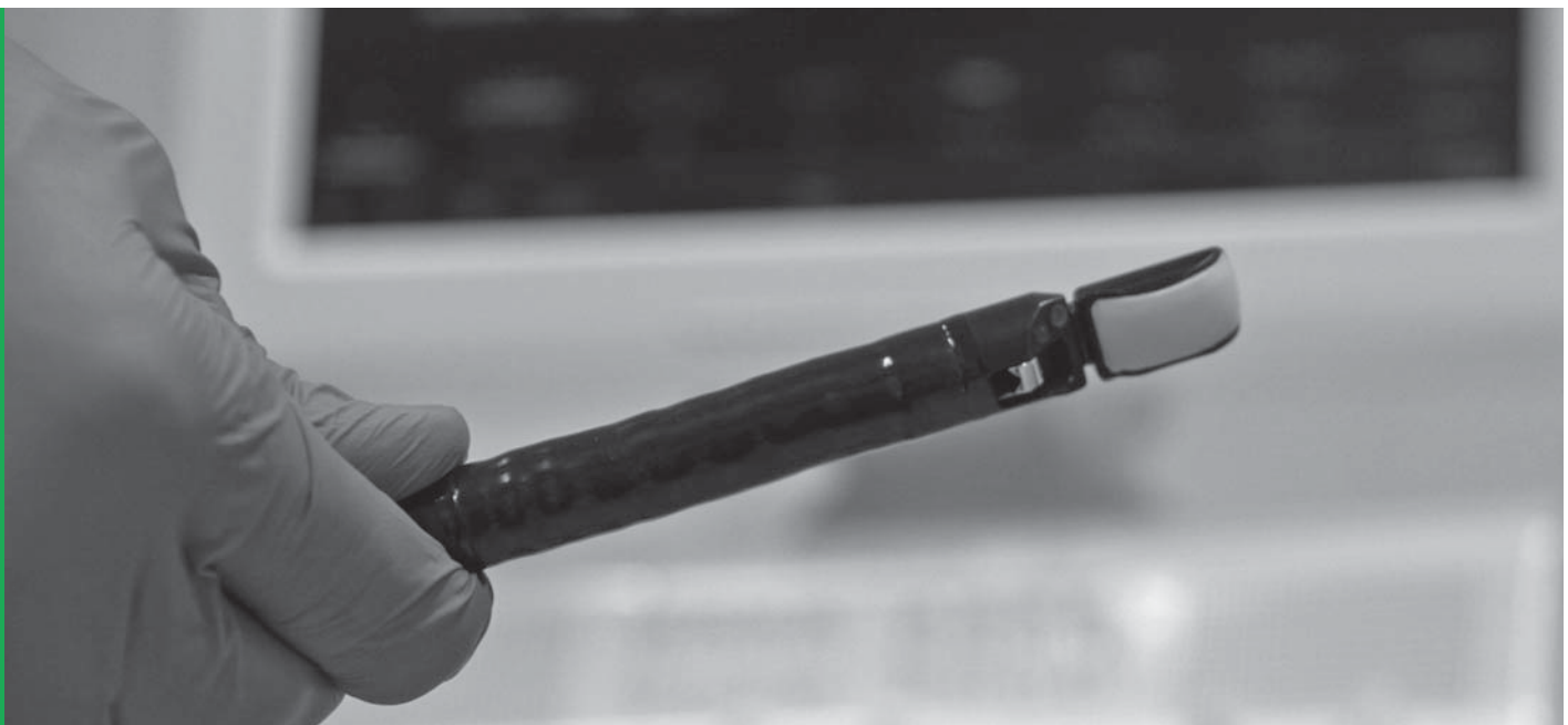
Dieser kleine Sonographiekopf ermöglicht einen Ultraschall während der Endoskopie – und somit eine exaktere Diagnosestellung.
