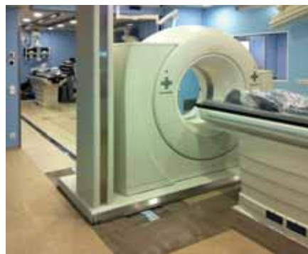
Der in Frankfurt installierte CT Somatom Definition AS gleitet bei Bedarf auf Schienen vom regulären Untersuchungs- in den Schockraum.
