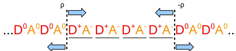
Abbildung 8.6: Schematische Darstellung der Streckschwingung einer ionischen Domäne innerhalb der neutralen Phase (Abb. nach [182]).
