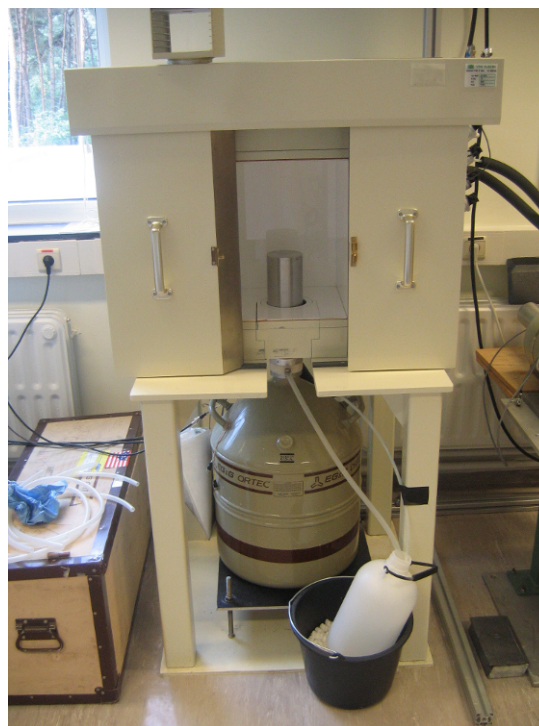
Abbildung 3.8: Nach der Bestrahlung wurden die aktivierten Proben und Monitore mit dem abgebildeten Germaniumdetektor spektroskopisch vermessen. Dazu wurden Proben und Monitore einzeln auf die Metallverkleidung des Kristalls in der Mitte des Bildes gelegt. Die Bleiabschirmung ist zur Reduktion des natürlichen Untergrundes.
