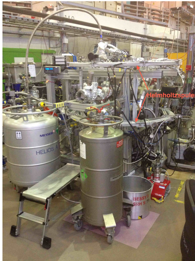
Abbildung 24: Anordnung mit Helmholtz-Spulenpaar für homogenes Magnetfeld
