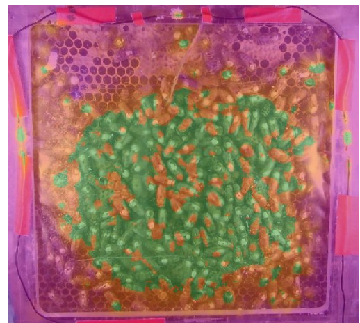
Abbildung 2.9: Per Photoshop erzeugtes Foto-Overlay aus Thermografie- und Digitalfoto (grüne Bereiche sind über 35°C warm)
