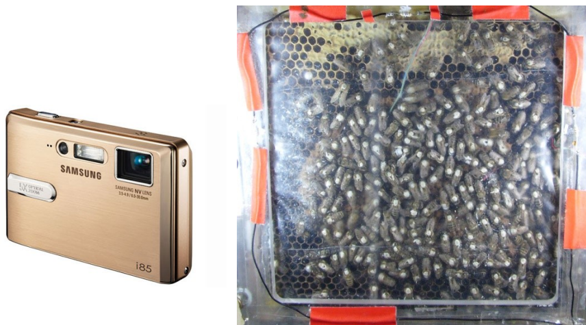
Abbildung 2.8: Digitalkamera mit randständiger Linse (links); mit der Kamera erzeugtes Foto (rechts)
