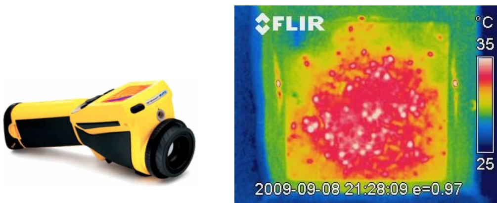
Abbildung 2.7: Thermografiekamera der Firma FLIR (links); mit der Kamera erzeugtes Foto (rechts)
