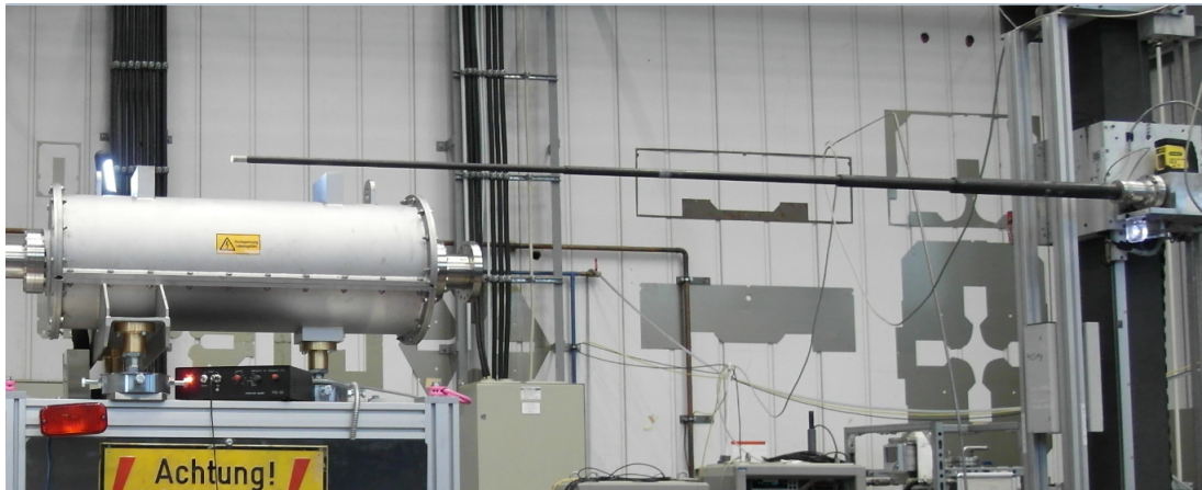
Abbildung 8.2: Gradientensonde bei der geometrischen Ausrichtung auf den gepulsten Quadrupol ("Mapping").
