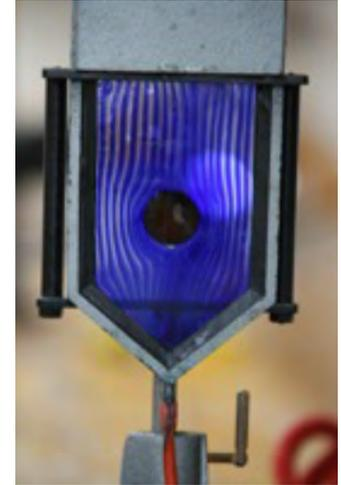
Abbildung 1: Strömungsfeld einer umströmten Kugel
