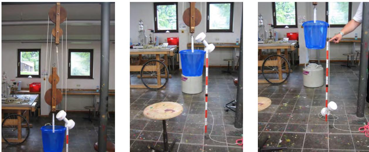
Abbildung 1: Demonstration eines Flaschenzuges. Links: Aufbau des Flaschenzuges, Mitte: Gewicht in Anfangsstellung, Rechts: Gewicht in Endstellung
