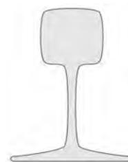
Abbildung 2: Querschnitt einer Vignolschiene
