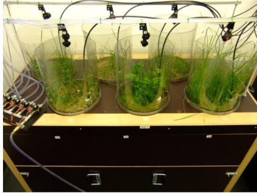
Abbildung 7: Aufbau eines TME-Versuchs in der Mesokosmenhalle von BiK-F, Frankfurt am Main. Sechs TME mit Feuchtesensoren und Sprühköpfen für eine automatisierte Bewässerung.
