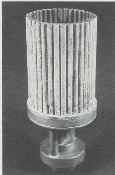
Skull-Schmelztiegel mit einem Durchmesser von 10 cm (links). Das Schnittbild (rechts) zeigt: A Schmelze, B Sinterkruste, C Abstrahlungskruste, D koaxiale, wassergekühlte Rohre bilden die Tiegelwand, E der Tiegel besteht aus zwei Hälften, die durch Glimmer elektrisch gegeneinander isoliert sind, F Kühlwassereinlaß, G Kühlwasserauslaß, H Hochfrequenzspule
