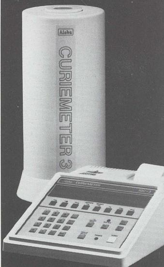
Druckendes Curiemeter. Datenausdruck in Curie oder Becquerel mit Patienten-ID. Selbständig kalibrierend. Feste Fenster für alle gängigen Isotope. Alle anderen Isotope werden durch Eingabe der Massenzahl bestimmt. Automatische Meßbereichumschaltung. Berechnung von Konzentration oder Probenvolumen.
