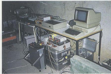
Abb. 5: Die Registrierzentrale des Hornberg-Experiments. Zu sehen sind ein Gravimeter (ganz links unten angeschnitten), die digitale Datenerfassung und zwei Analogregistrierungen (rechts), mit denen der Datenfluß kontinuierlich überwacht wurde.
