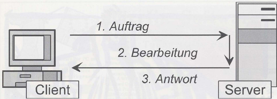
Abb. 1: Das Client/Server-Modell beschreibt den Interaktionsablauf zwischen Software-Komponenten.
