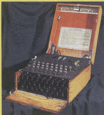
Die Enigma-Maschinen (hier im Nachbau) besaßen Ähnlichkeit mit einer Schreibmaschine. Der getippte Buchstabe wurde im Inneren verschlüsselt, das Resultat leuchtete im Buchstabenfeld auf.
