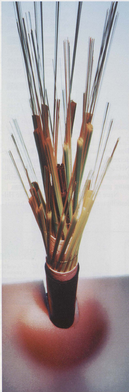
Über jede Faser dieses Glasfaserkabels lassen sich 30.000 Telefongespräche übertragen. Der Faserkern besteht aus einem hochreinen Quarzglas, das in einem aufwendigen Verfahren zu haarfeinen Fasern gezogen wird. Zum Schutz sind die einzelnen Fasern mit einem Kunststoffmantel umhüllt. [Siemens-Pressbild]
