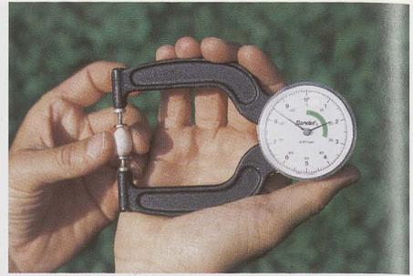
Eier der Höhlenbrüter werden in Länge und Breite mit einem speziellen Meßtaster – bis zu einer Genauigkeit von einem Zehntel Millimeter vermessen.
