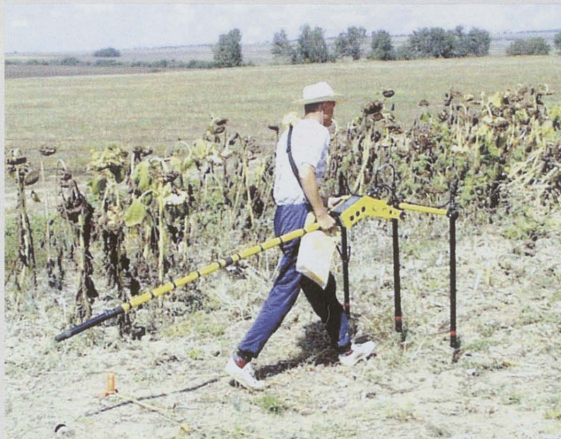
Abb. 1a: Geomagnetische Flächenprospektion zur Auffindung unterirdischer Strukturen.
