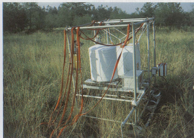
Abb. 2: Der Gaschromatograf HAGAR (weißer Kessel vorne) direkt nach der Landung der Ballongondel nach dem ersten Ballonflug am 14. Mai 1998 von Aire sur l'Adour (Südfrankreich) aus.
