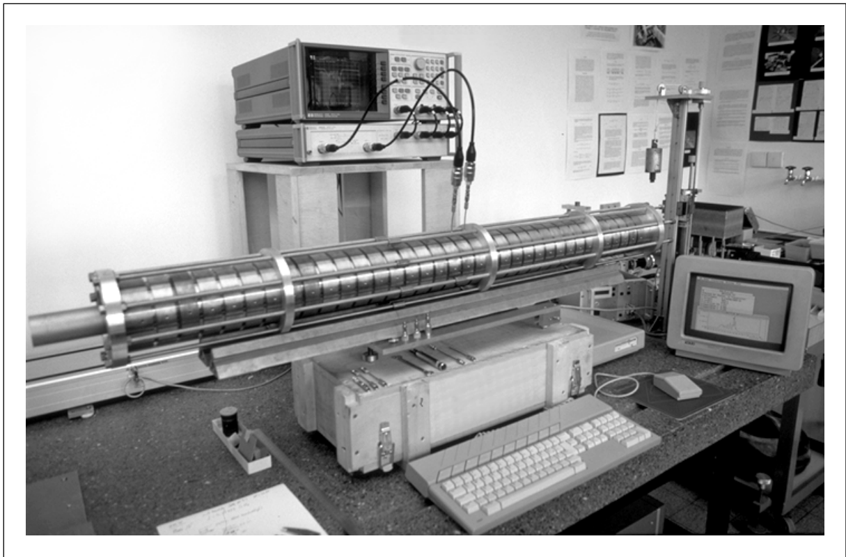
Abb. 4.4: Der 36-Zeller auf dem automatisierten Störkörpermeßstand
