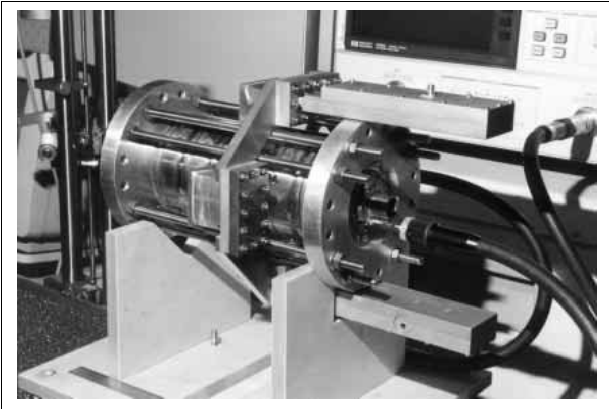
Abb. 5.23: 7-Zeller mit zwei gefalteten Dämpferhohlleitern
