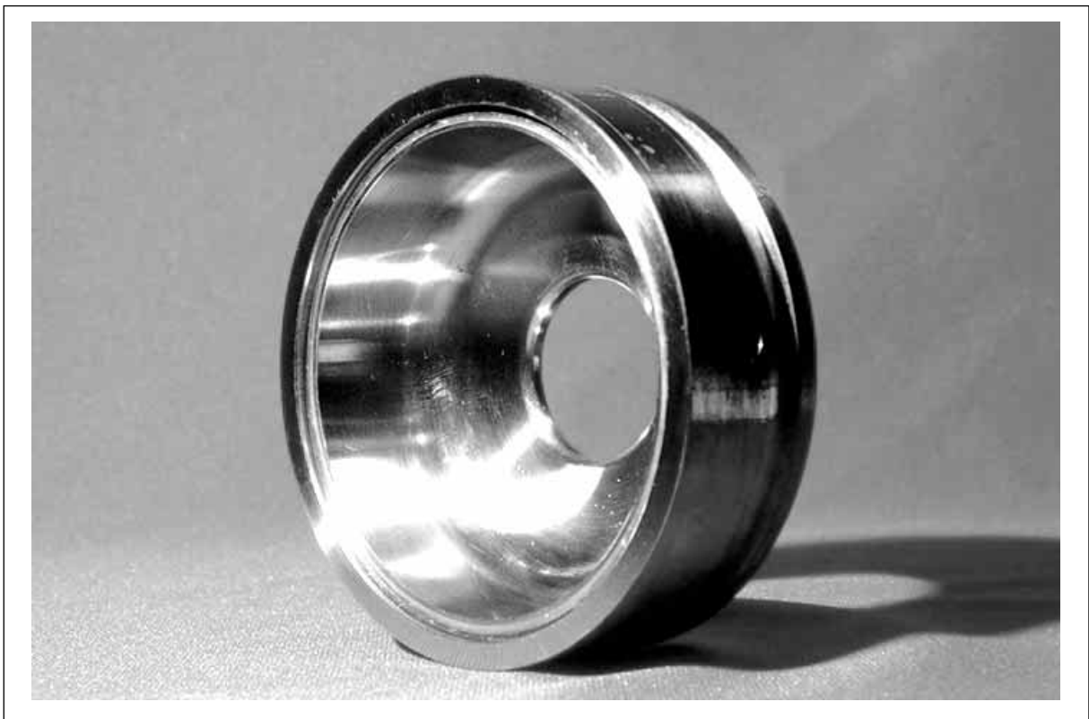
Abb. 5.1: Eine einzelne Kupferzelle der SBLC-Beschleunigerstruktur
