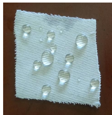
Abbildung 19: Wassertropfen auf mit Silicondioxid beschichteter Baumwolle
