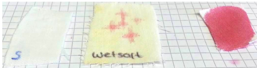
Abbildung 20: Baumwolle, beschichtet mit Silicondichtstoff, beschichtet mit Wetsaft CTA und unbeschichtet nach dem Abwischen des Rote-Beete-Safts (von links nach rechts)
