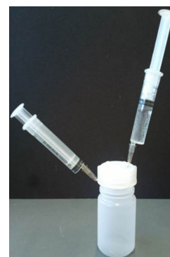
Abbildung 49: Apparatur zur in-situ-Erzeugung von Fluorwasserstoff
