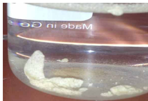
Abbildung 27: Sand mit hydrophober Beschichtung in Wasser
