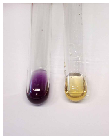
Abbildung 15: positiver Nachweis mit Alkoxy-Dichtstoff (links), negativer Nachweis mit Amin-Dichtstoff (rechts)
