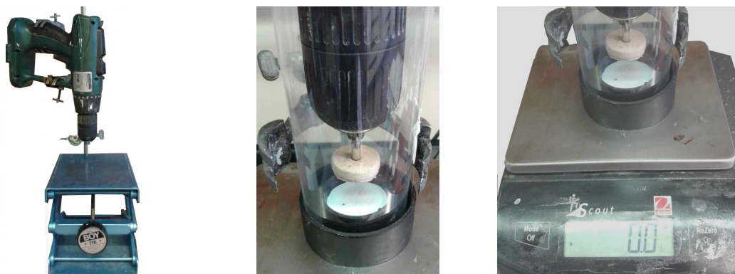
Abbildung 41: Versuchsaufbau mit Akkuschauber, genauerer Blick auf den Schleifaufsatz und auf den Teil des Aufbaus auf der Laborwaage (von links nach rechts)
