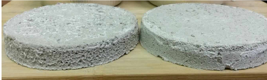
Abbildung 43: unbehandelte Zement (links), Zement mit pyrogener Kieselsäure (1 Gew.-%) (rechts)
