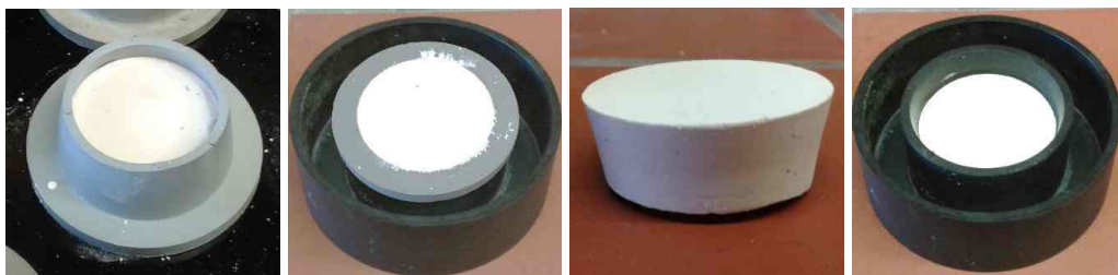
Abbildung 40: Herstellung von Gips-Rohlingen für den maschinellen Abrieb: Gukoring als Gussform, Darstellung der aneinander angepassten Gukoringe, Gipsrohling in Form eines Kegelstumpfs, Gips-Rohling im großen Gukoring für den Versuchsaufbau (von links nach rechts)
