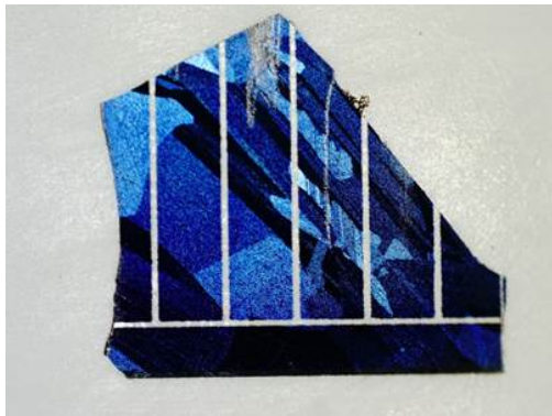
Abbildung 47: unbehandeltes Bruchstück einer polykristallinen Solarzelle (links), nach 5 min in 80° C warmer Natriumhydroxid-Lösung (rechts)
