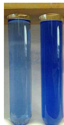
Abbildung 42: Probenlösung mit dem Abrieb des feinkörnigen und des grobkörnigen Schleifpapiers (von li nach re)
