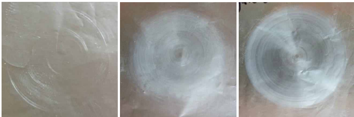
Abbildung 39: unbehandelte Aluminiumfolie als Blindprobe, Behandlung mit der Zahncreme Ajona® Stomaticum , Behandlung mit der Zahncreme Colgate® Sensation White Zahncreme (von links nach rechts)
