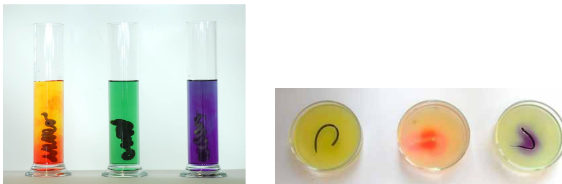
Abbildung 13: im Standzylinder: Acetoxy-Dichtstoff (sauer), Alkoxy-Dichtstoff (neutral), Amin-Dichtstoff (basisch) (von links nach rechts); im Agar-agar: Alkoxy-Dichtstoff (neutral), Acetoxy-Dichtstoff (sauer), Amin-Dichtstoff (basisch)(von links nach rechts)
