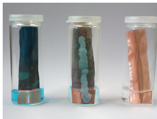
Abbildung 17: Vergleichsprobe mit Essigsäure, sauer vernetzender Silicondichtstoff in dest. Wasser und Blindprobe mit dest. Wasser (von links nach rechts)
