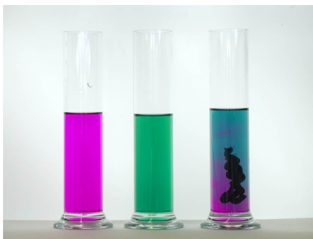
Abbildung 14: negativer Nachweis, positiver Nachweis, Alkoxy-Dichtstoff (von links nach rechts)
