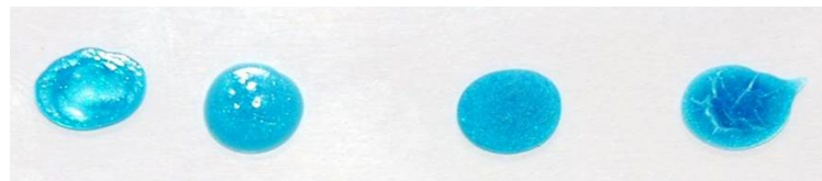
Abbildung 34: Basislack, Zusatz von 0,5 g Siliconharz, Zusatz von 0,05 g und von 0,1 g Siliciumdioxid (von links nach rechts)
