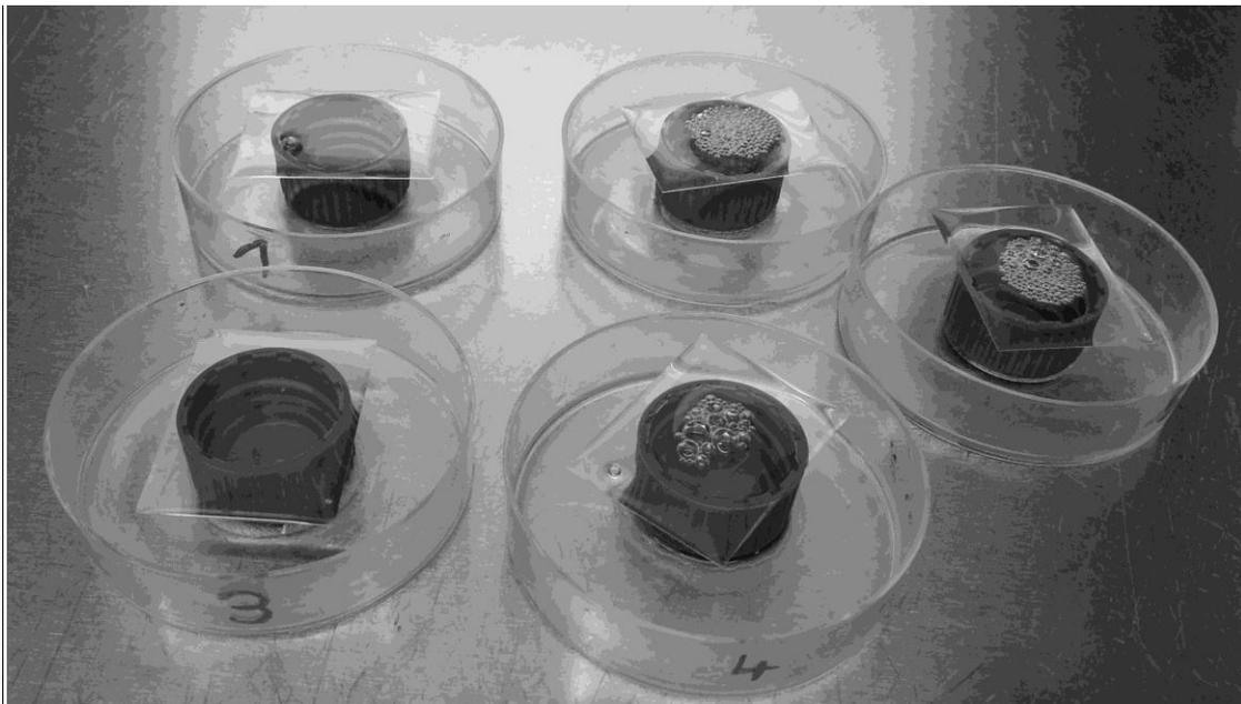
*Abbildung 19: Unterer Teil der Färbvorrichtung; aufliegende Deckgläschen mit Zellrasen beschickt mit 500 µl Primärantikörperlösung*
