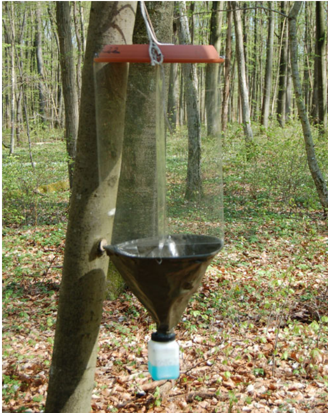
Abb. 3: Bodennahe Flugfensterfalle zur Erfassung der holzwohnenden Käfer.
