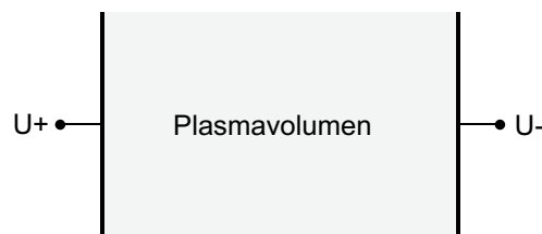
Abbildung 2.4: Eine einfache Geometrie zur Erzeugung einer klassischen Niederdruckentladung.
