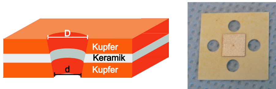
Abbildung 2.7: Schema und Foto einer „Mikrostrukturelektrode“ (MSE) zur Erzeugung eines Hochdruckmikroplasmas. Die eingezeichneten Durchmesser D und d betragen je nach Ausführung 50\ \mu\text{m} bis 400\ \mu\text{m} . Die Dicke des gesamten Mehrschichtsystems beträgt 130\ \mu\text{m} bis 650\ \mu\text{m}
