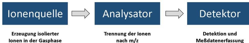
Abbildung 1.7: Funktionseinheiten eines Massenspektrometers
