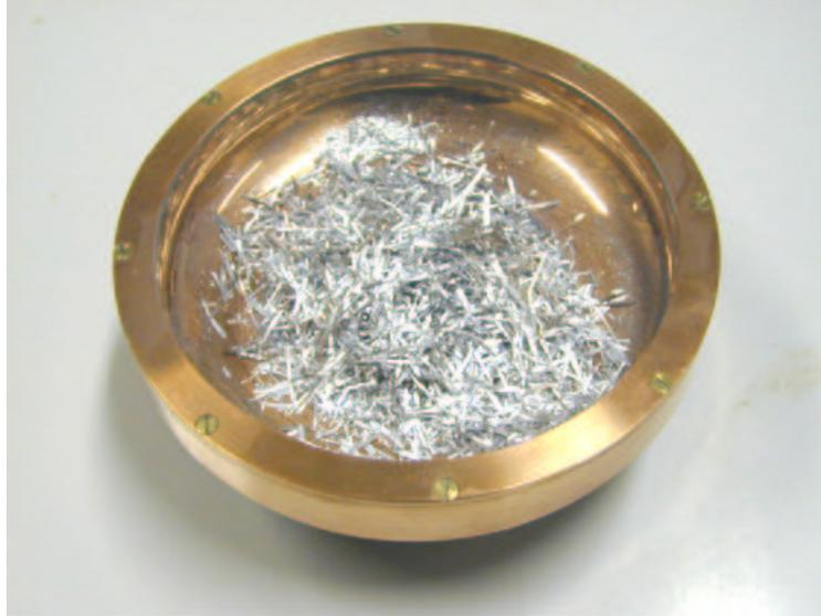
Abbildung 5.9: Meltspinteller mit abgeschreckten Zn-Mg-Ho-Bändern (Dicke etwa  $30 \mu\text{m}$ )
