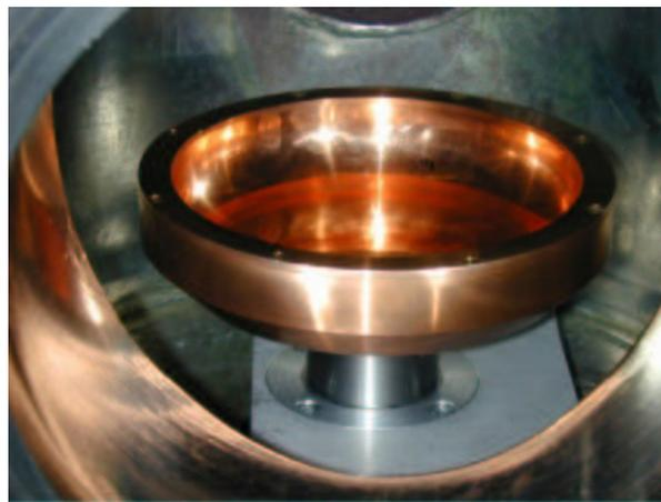
Abbildung 2.6: In die Schmelzanlage integrierter Meltspinaufbau
