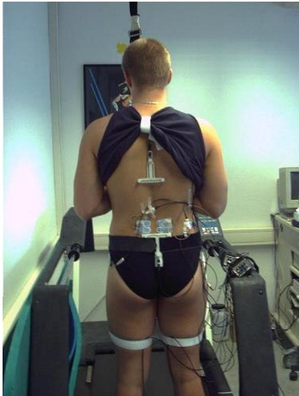
**Abbildung 8:** Photo des Messplatzes mit Tripletposition. Der Ultraschallempfänger ist nicht sichtbar und steht normalerweise hinter dem Probanden.
