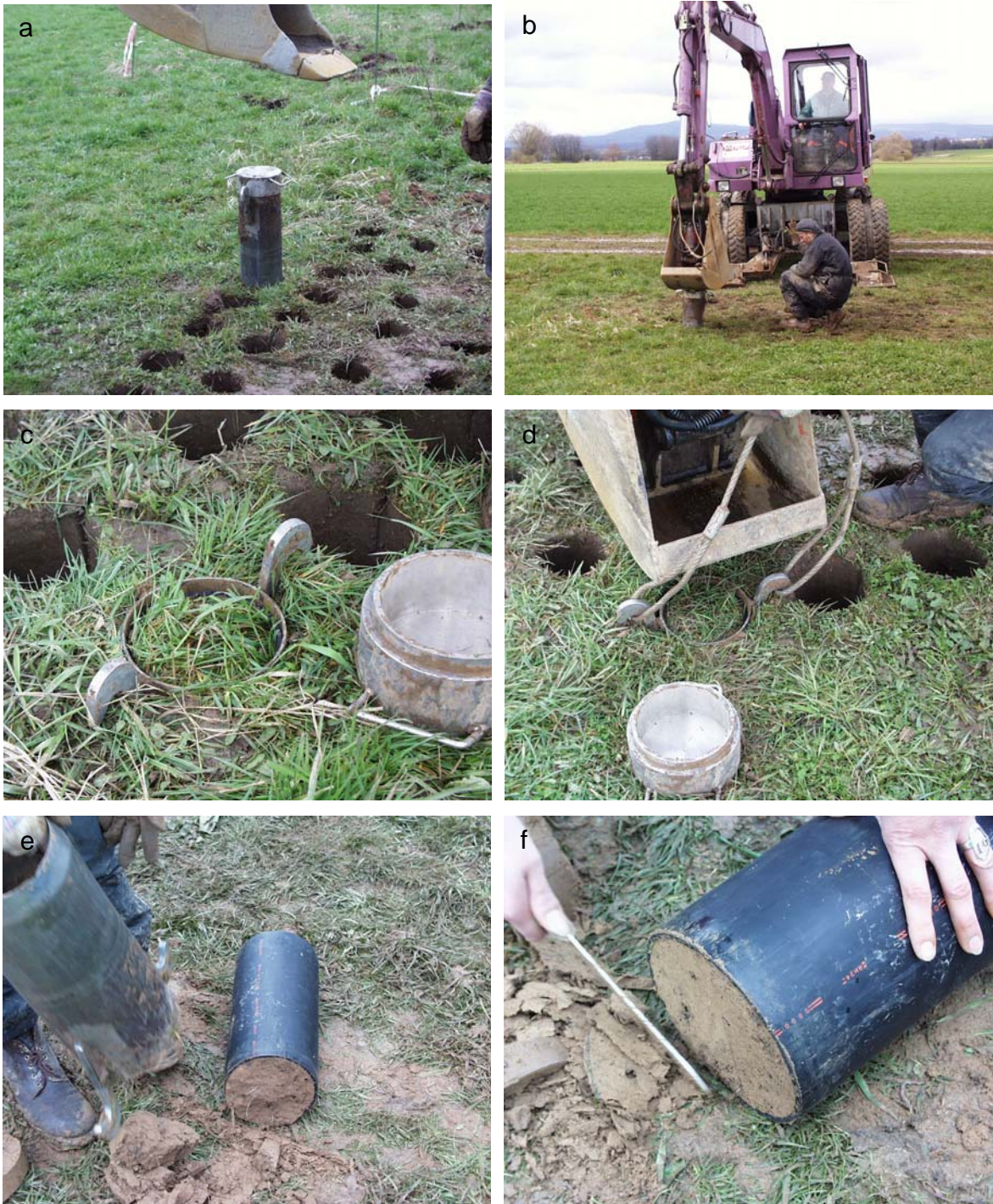
Abb. 2.3: Extraktion der TMEs: Aufsetzen des Extraktors (a), Eindrücken des Extraktors (b), Verdichtungsüberprüfung (c), Herausziehen des Extraktors (d), Entnahme der ummantelten Bodensäule (e) und Abschneiden überstehenden Bodens (f).
