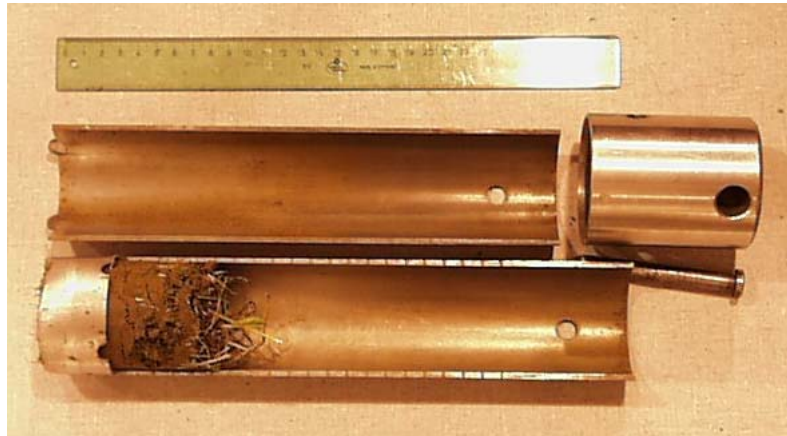
Abb. 2.9: Stechzylinder ( \varnothing = 5.6 cm) zur Entnahme von Bodenproben für die Untersuchung der Enchytraeenzönose einschließlich einer entnommenen Probe mit einer Schichttiefe von 5 cm.
