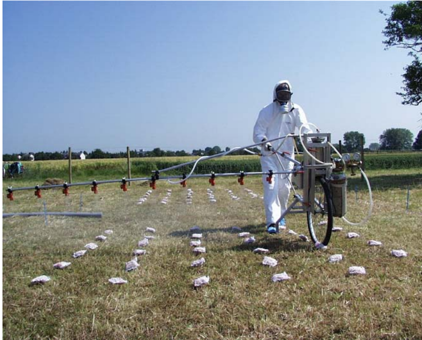
Abb. 2.8: Applikation der Modellchemikalie mittels eines Parzellenspritzgerätes. Freiland-Validierungsstudie Flörsheim.
