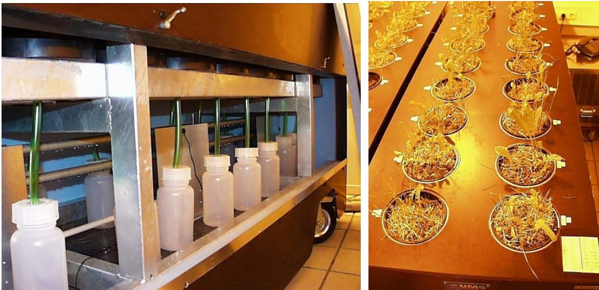
Abb. 2.5: Seitlicher Einblick in einen Klimacontainer mit Polyethylen-Weithalsflaschen zur Sickerwassergewinnung sowie Aufsicht auf einen geschlossenen Klimacontainer mit randomisiert verteilten TMEs.
