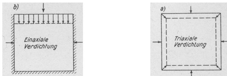
Abbildung 24: Einaxiale und triaxiale Verdichtung mit Setzung einer Lockergesteinsmasse (HAEFELI 1967: 4).
