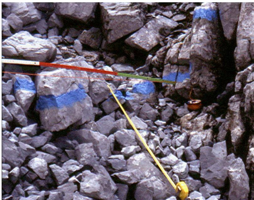
Abbildung 62: Typischer Meßaufbau für die Aufnahme der Schuttkörperprofile (eigene Aufnahme).
