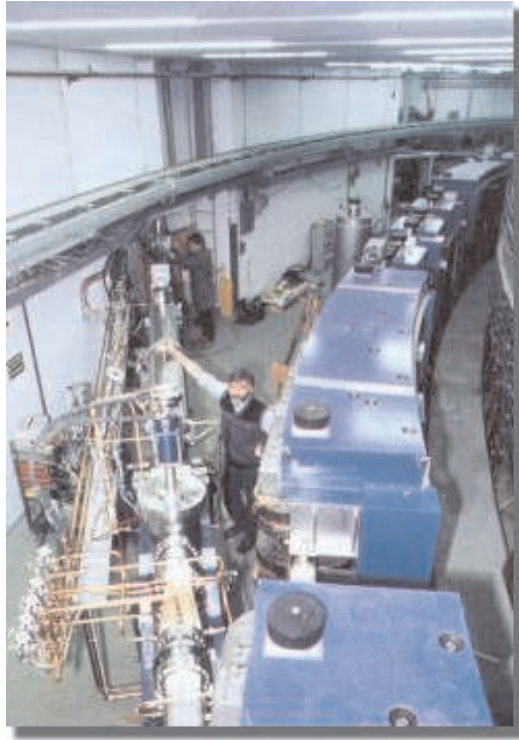
Abbildung 3.20: Blick in den Speicherring DORIS III bei HASYLAB. Zu erkennen sind die Magnete zur Umlenkung des Strahles (blau) entlang des Speicherrings, sowie ein Strahlrohr, das tangential aus dem Speicherring führt und der Auskopplung der Synchrotron-Strahlung dient (entnommen von [BW3WE])
