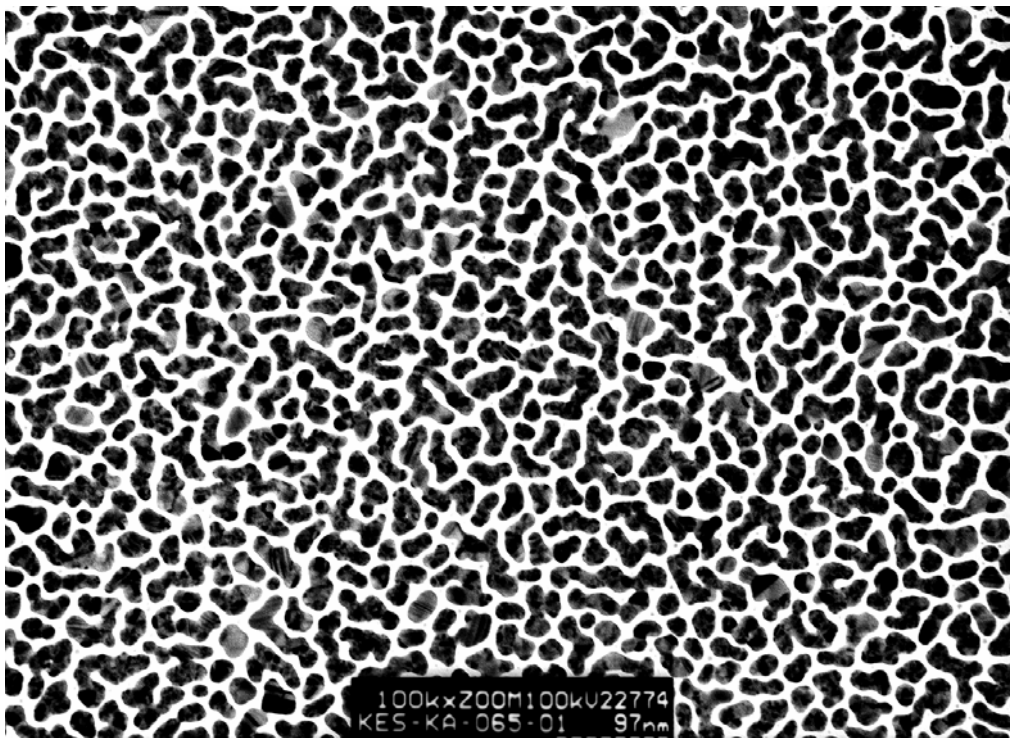
Abbildung 52: Transmissionselektronenmikroskopische Aufnahme eines mit Silber besputterten Graphitnetzes. Nominelle Schichtdicke 1 nm.
