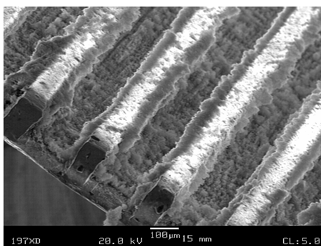
Abbildung 42: REM-Aufnahme eines mittels CVD mit Aluminiumoxid beschichteten Folienplättchens. 33
