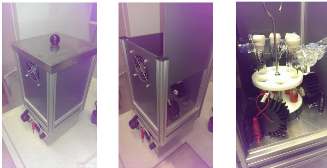
Abbildung 27: Bilder des individuell angefertigten Photoreaktors. Reproduziert mit Erlaubnis von Adv. Synth. Catal. 2017 , 359, 1308-1319. Copyright 2017 Wiley-VCH.
