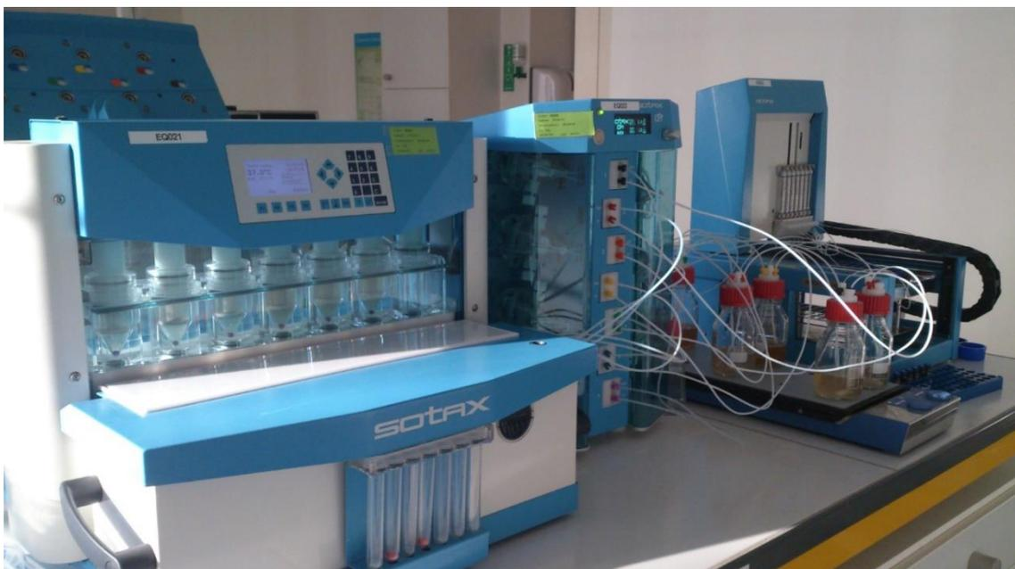
Abbildung 11: Durchflusszelle mit A4D
