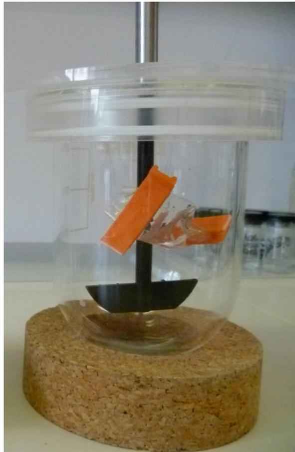
**Abbildung 7: Darstellung der Wirkstofffreisetzung mittels Dialysesack im Minivessel mit Minipaddle, Dialysiermembran aus regenerierter Cellulose**
