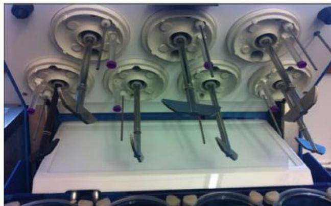
**Abbildung 1: Dialysesack modifiziert nach Kumar et al., verwendet im Rahmen der Doktorarbeit mit Genehmigung des Elsevier-Verlages, Originalbeschriftung: „Fig. 1. Sotax® USP II adapted to hold the dialysis sacs. Top part of each vessel is attached with the plastic adapter to hold the dialysis sacs.“ [52]**
