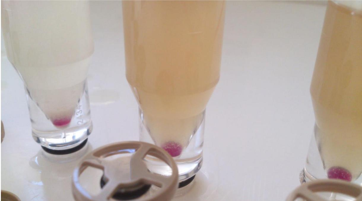
**Abbildung 32: Zellen des A4D nach Beendigung der Freisetzungsuntersuchungen mit erkennbarem Präzipitat**
