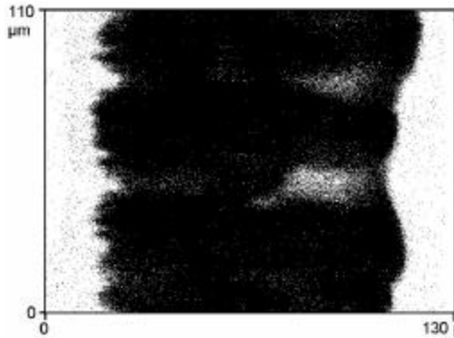
Abbildung 4.16 e: Ladungssammlungsbild, seitlicher Einschuss, Ereignisse mit Pulshöhen über 27 % Effizienz werden schwarz dargestellt.
