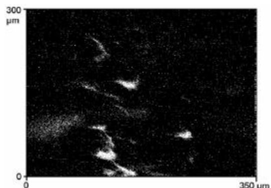
Abbildung 4.14 f: Bereiche in denen mehr als 6 % der primär erzeugten Ladungsträger gesammelt werden.
