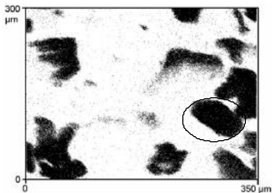
Abbildung 4.21 a: Ladungssammlungsbild, der selektierte Bereich aus dem das Spektrum in Bild 4.21 b erzeugt wurde, ist durch eine Ellipse gekennzeichnet.
