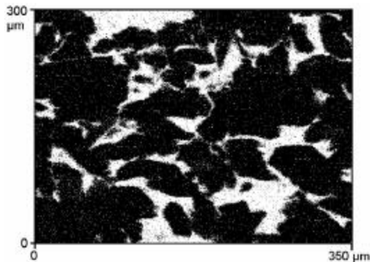
Abbildung 4.18 b: Bereiche in denen mehr als 40 % der primär erzeugten Ladungsträger zum Signal beitragen, nach einer Dosis von 10^{10} Ionen/cm 2 .
