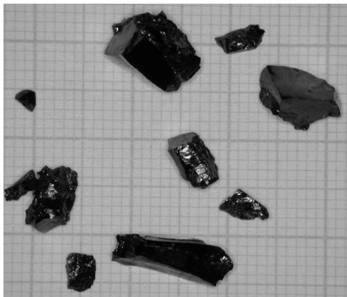
**Abbildung 6.1:**  $\text{LaMnO}_3$ -Einkristalle aus einem Skull-Lauf auf Millimeterpapier.
