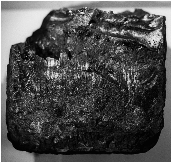
**Abbildung 4.4:** Aufgeschlagener Schmelzregulus bei einer Ausgangszusammensetzung von  $La_{0,65}Sr_{0,35}MnO_3$ , Tiegelradius 4 cm.
