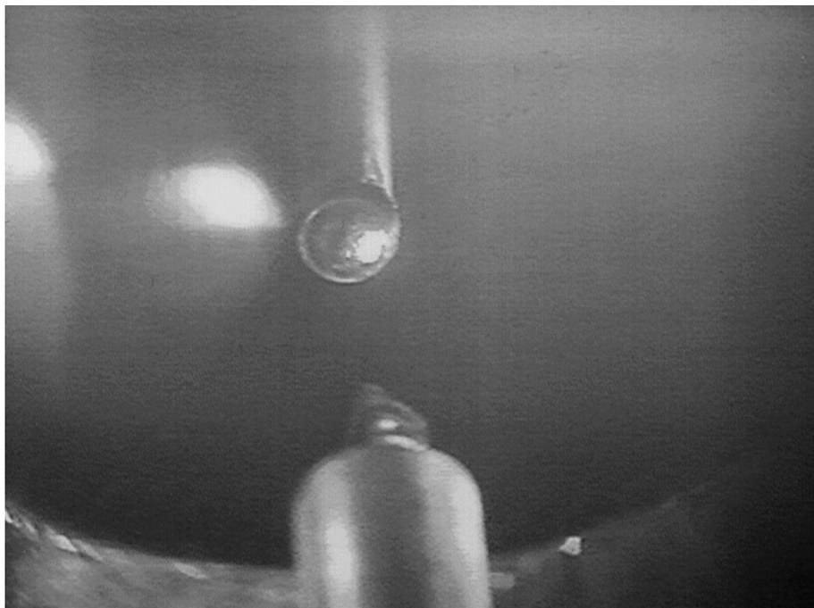
**Abbildung 4.5:** Videobild vor Einschalten des Lasers: Unten ist der Keim, oben der Fütterstab zu erkennen. Der Blickwinkel beträgt etwa  $30^\circ$ , der Durchmesser des Fütterstabes 2,4 mm.
