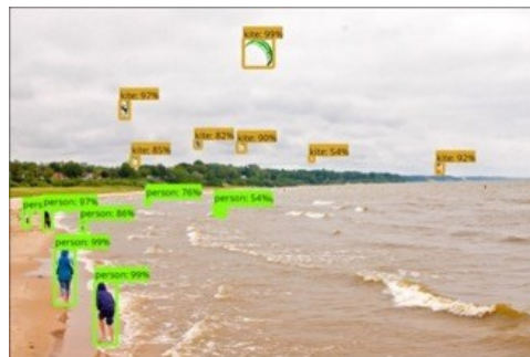
Abb. 14: Objekt-Klassifizierung mit der TensorFlow Object Detection API, Quelle: Google, Open Source, 2016, https://github.com/tensorflow/models/tree/master/research/object_detection . ^
