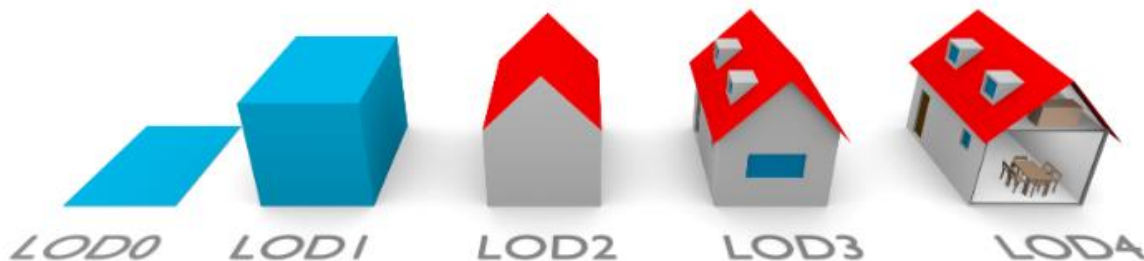
Abb. 4: Visualisierung der 5 Detaillierungsgrade LOD0 bis LOD4, Quelle: [2]
