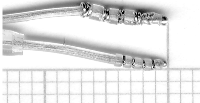
Abb. 13: Vergleich der Implantatköpfe von 5+1 "groß" und 5+1 "klein"
