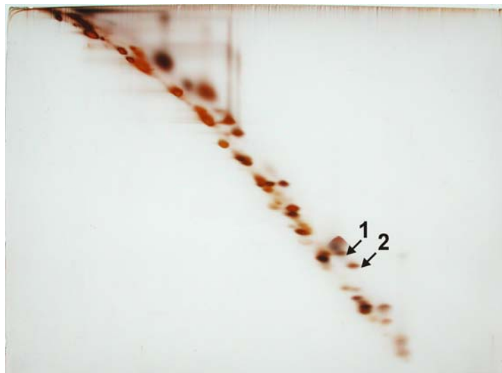
Abb. 5.35 dSDS-PAGE von Komplex I nach der Modifizierung mit NEM und NFM (Silberfärbung). Spot 1 fluoresziert bei 488/520 nm (Anregung/Fluoreszenz). Details zur Methodik, siehe Kapitel 8.6.5. Weitere Informationen zur Abbildung, siehe Text.
