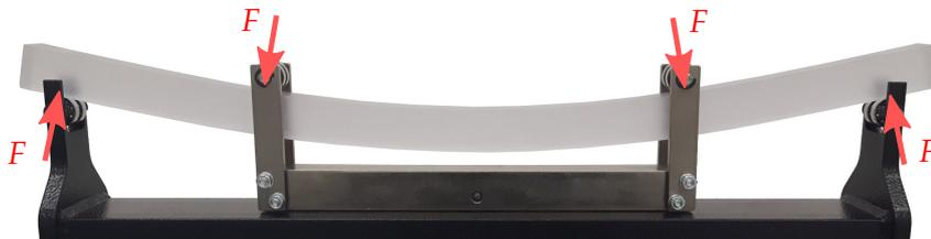
Abbildung 3.15: Vierpunktbiege-Anlage mit Polycarbonat-Balken bei maximaler Auslenkung. Die einwirkenden Kräften  $F$  sind eingezeichnet.
