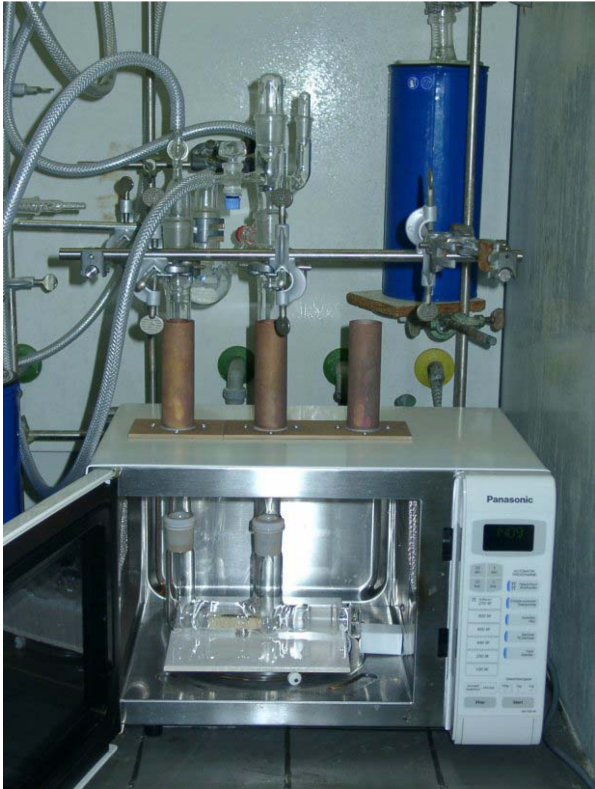
Bild 6: Aufbau der Mikrowellenapparatur für Silicium / Gas Reaktionen
