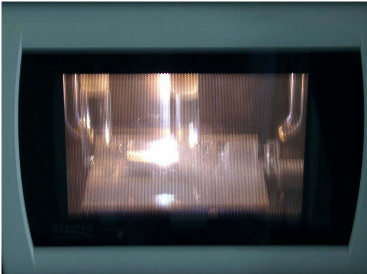
Bild 9: Plasmaentladung während einer Reaktion
