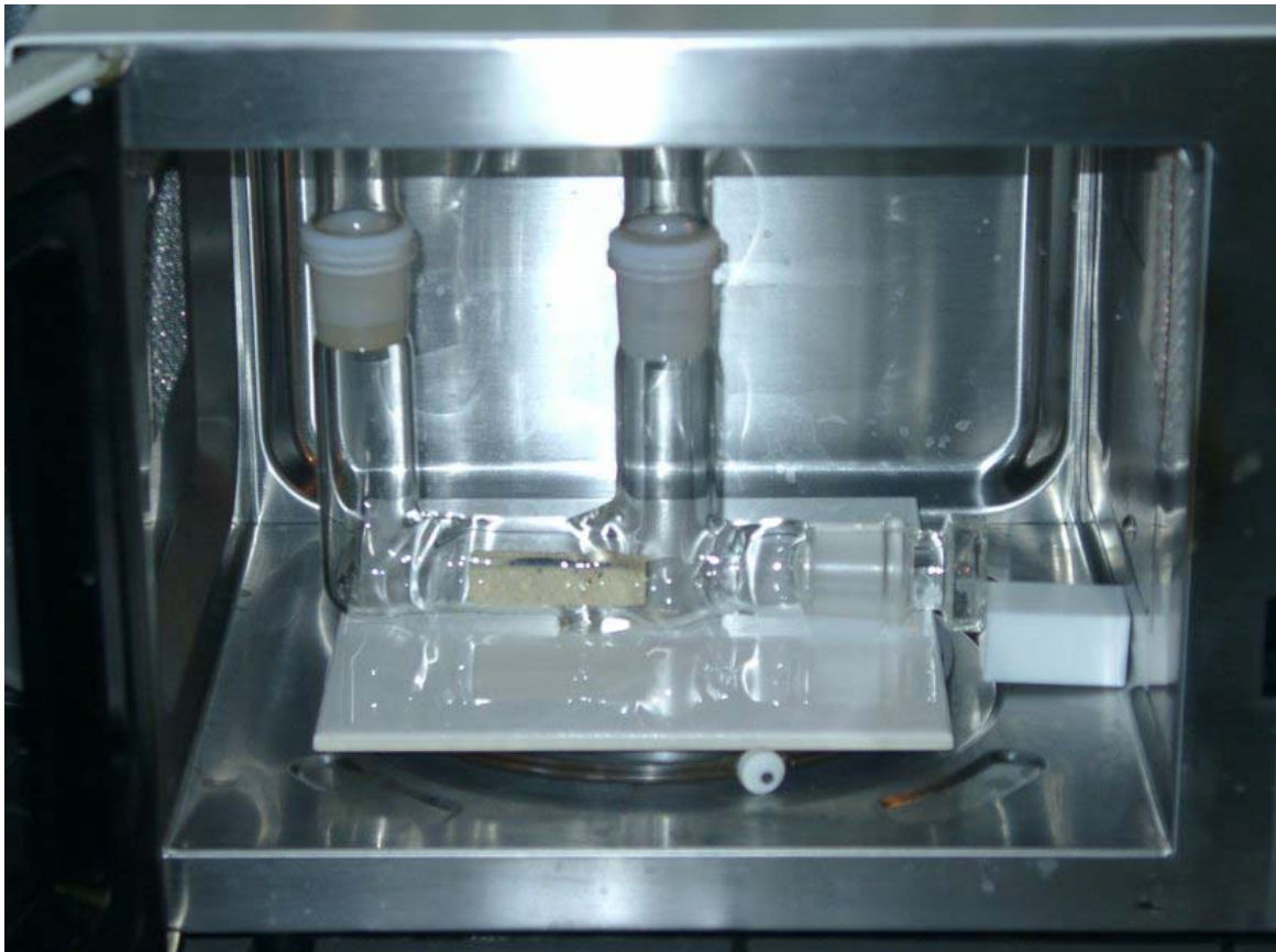
Bild 7: Innenraum für Silicium/Gas-Reaktionen
