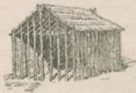
Fig. 180. Hütte der Baschilange; zwei Wände im Holzgerüst ohne Borken- und Leimbekleidung (nach Pogges Tagebuch).
