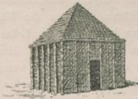
Fig. 181. Hütte der Bali ohne Grasdeckung des Daches und Leimbewurf der Wände (nach Zintgraffs Schilderung).
