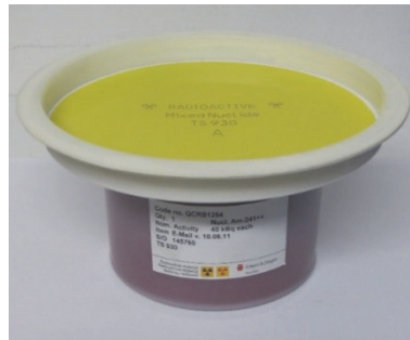
Abb. 33: Referenzstrahler Referenzstrahler TS 930 der Firma Eckert & Ziegler Nuclitec GmbH
