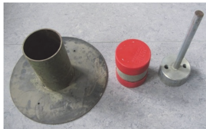
Abb. 28: Gerät zur Probenentnahme für Tiefenprofil Führungszylinder, Stechzylinder mit Deckeln und Schlagkopf
