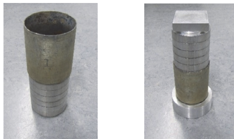
Abb. 30: Hilfsmittel zur Entnahme der Schichten aus dem Probenzylinder links: für lockere Proben; rechts: für festere Proben
