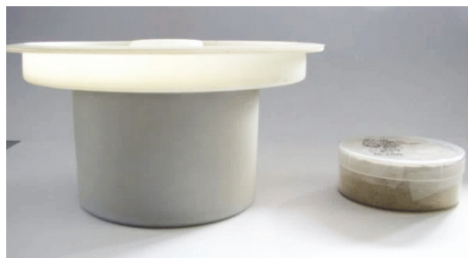
Abb. 40: Probengefäße Seitenansicht von gefüllten Probengefäßen. Links: Marinellibecher, rechts: Stülpdeckeldose
