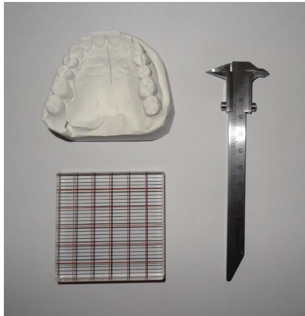
Abbildung 18: Oberkiefermodell, Messplatte nach Schmuth, Schieblehre "Münchener Modell" [eigene Quelle]
