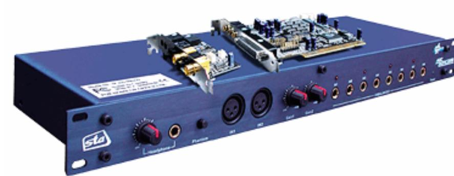
Abbildung 8.8 Foto der DSP-Einheit mit 8 Eingangs- und 8 Ausgangskanälen
