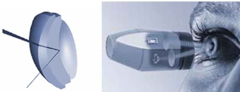
Abbildung 2.1 Nicht-invasive Blutzuckermessung in der Vorderkammer des Auges [<http://www.itiv.uni-karlsruhe.de/>]
