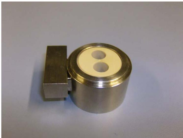
Abbildung 4.22 Helmholtz – Resonator PA - Zelle
