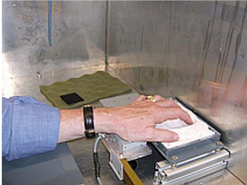
Abbildung 5.1 Nicht-invasive photoakustische Glukosemessung am Handballen. Damit wir in die gleiche Stelle messen können, wurde eine Auflagehilfe für die Handhaltung gebaut.
