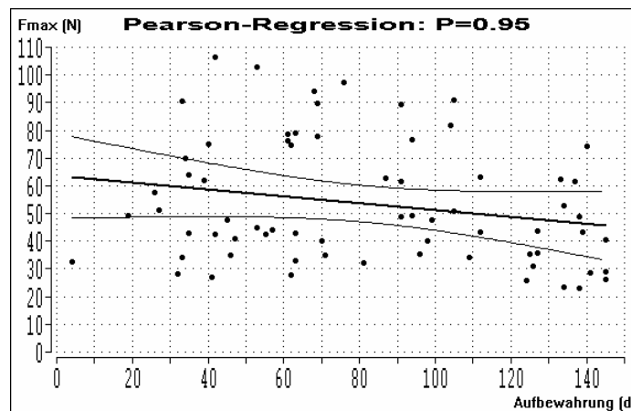
Abb. 19: Regressionsgerade; Einfluss der Aufbewahrungsdauer in Tagen auf die Maximalkraft beim Reißen in Newton; Überschreitungswahrscheinlichkeit p=0,073 ; Regressionskoeffizient b= -0,123
