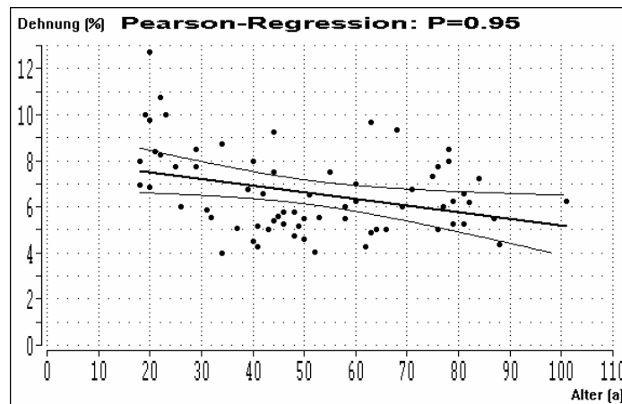
Abb. 18: Regressionsgerade; Einfluss des Lebensalters in Jahren auf die prozentuale Dehnung bei 10 N; Überschreitungswahrscheinlichkeit p = 0,004 ; Regressionskoeffizient b = - 0,029
