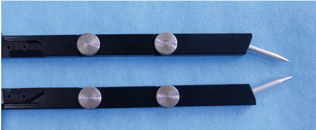
Abb.4 3. Generation Tasterarme, pulverstrahlbeschichtet
