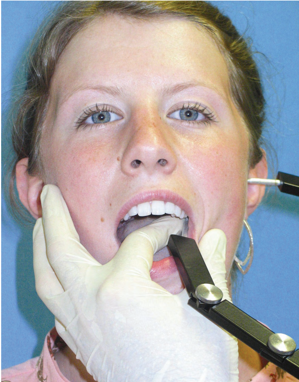
Abb.6 Test der Tasterarme der 3.Generation in der Mundhöhle
