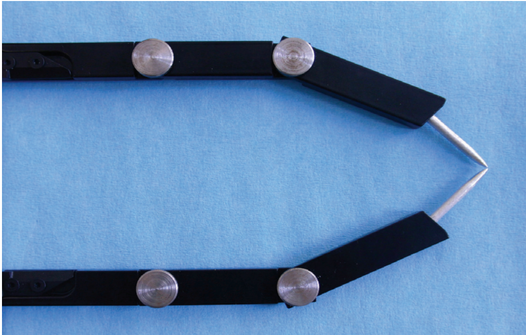
Abb.10 abgewinkelte Tasterarme mit austauschbarer Spitze
