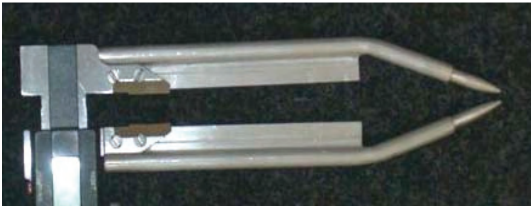
Abb.2 Tasterarme der ersten Konstruktion aus Aluminiumprofil, nicht flexibel abwinkelbar
