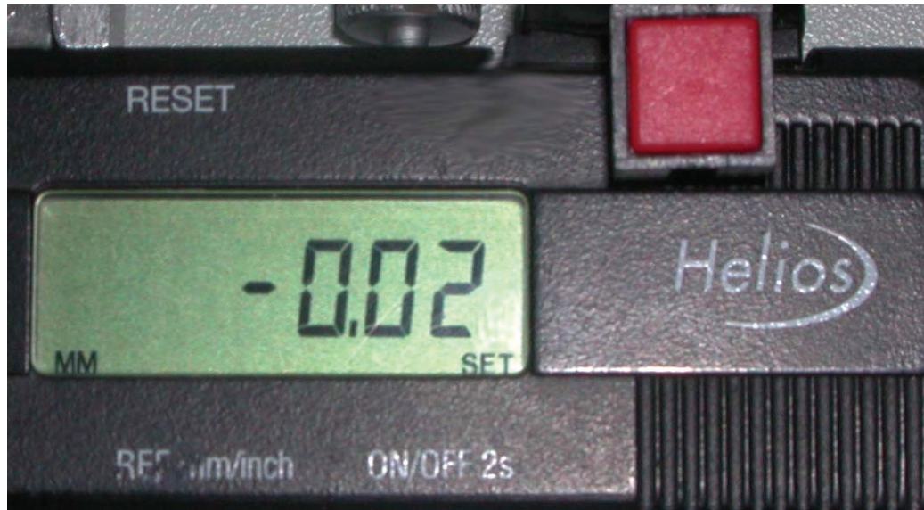
Abb.11 LED-Anzeige und Auslöser (roter, viereckiger Knopf) des Messinstruments
