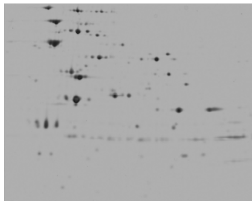
Abb. 8 Mit PD-Quest bearbeitetes 2D-Gel nach Subtraktion von Artefakten und Hintergrundfärbung
