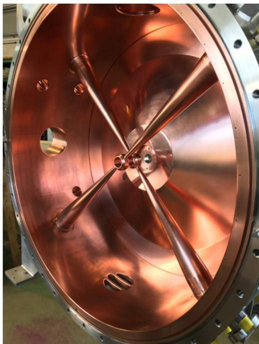
Abbildung 6: CH1 ohne Deckel, verkupferte und polierte Tankoberfläche.
