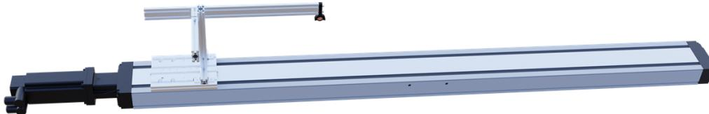
Abbildung 4.7: Lineares Schienensystem. Auf der Schiene montiert ist die frei fahrbare Probenhalterung.
