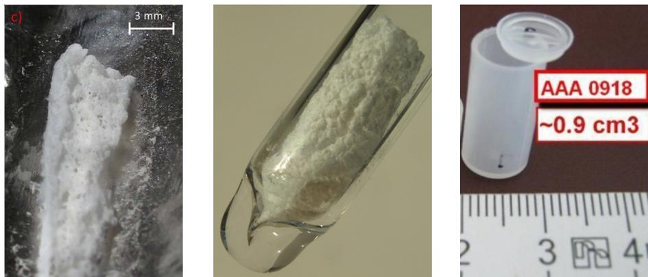
Abbildung 3.5:  $^{10}\text{Be}$  Probe. Links abgebildet ist das BeO unmittelbar nach der Herstellung. In der Mitte ist das Probenmaterial zu sehen, welches in die rechts dargestellte PE ( $\text{C}_2\text{H}_4$ ) abgefüllt wurde [35].
