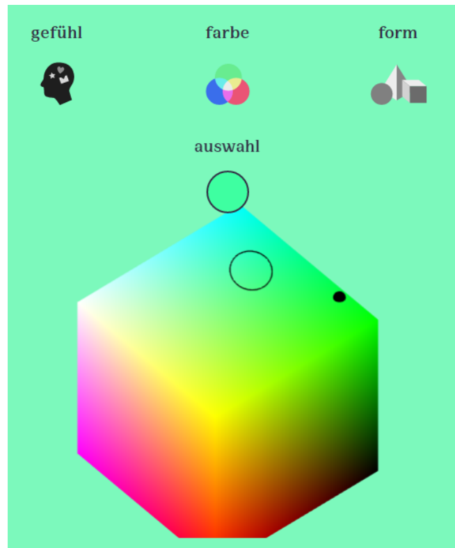
Ein erster Blick auf das Audiovis I/O Interface mit dem RGB-Cube zur Farbauswahlhilfe. Die genaue Gestaltung kann sich im Entwicklungsprozess noch ändern.
