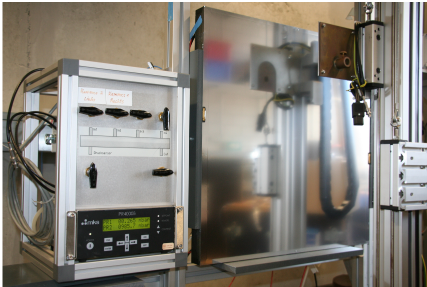
Abbildung 6.4: Eingespannte Auslesekammer mit Druckmessgerät und Quellenhalterung
